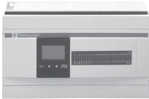
Компактный контроллер Twido с индикатором
